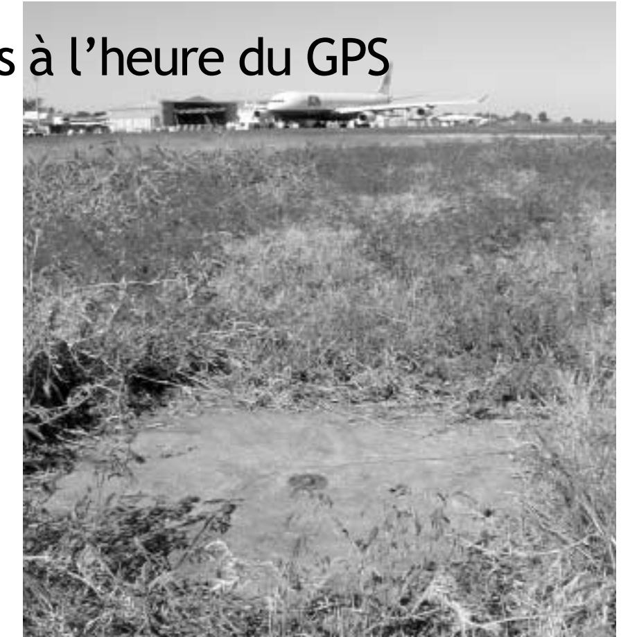
Le point GPS fondamental de l'aéroport de Tahiti Faa'a, matérialisé par un clou, est situé entre le parking des gros porteurs et la piste.
