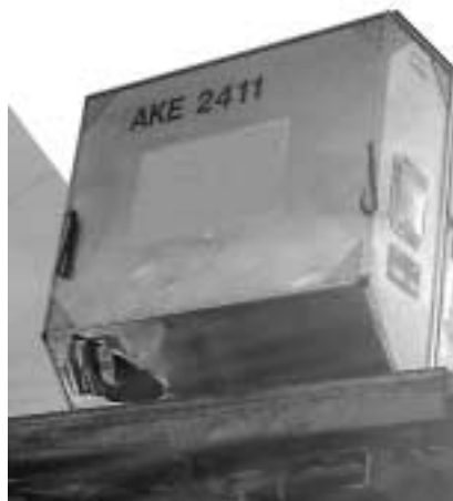
Un conteneur à bagages perforé représente un danger tant pour les passagers que pour le personnel au sol qui le manie.
