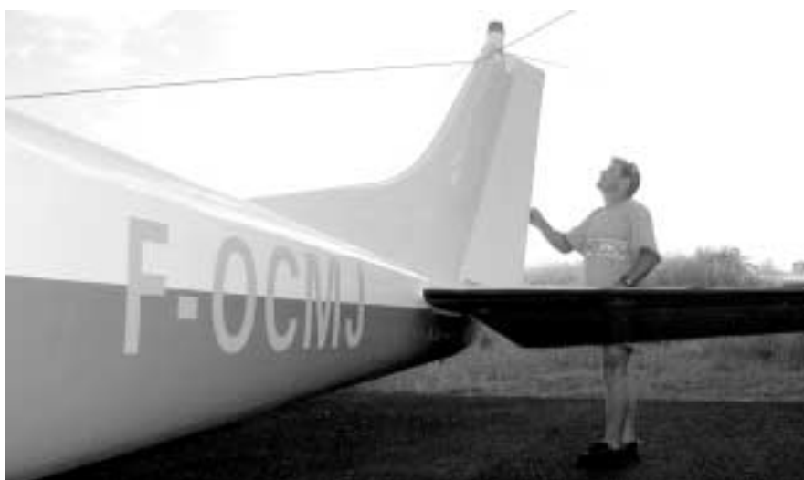
Avant chaque départ, le pilote inspecte l'avion en plusieurs points. La gouverne de direction en fait partie. C'est un des nombreux gestes que l'élève pilote apprend lors de sa formation.
